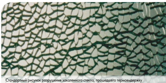
Стандартный рисунок разрушения закаленного стекла, прошедшего термовыдержку
